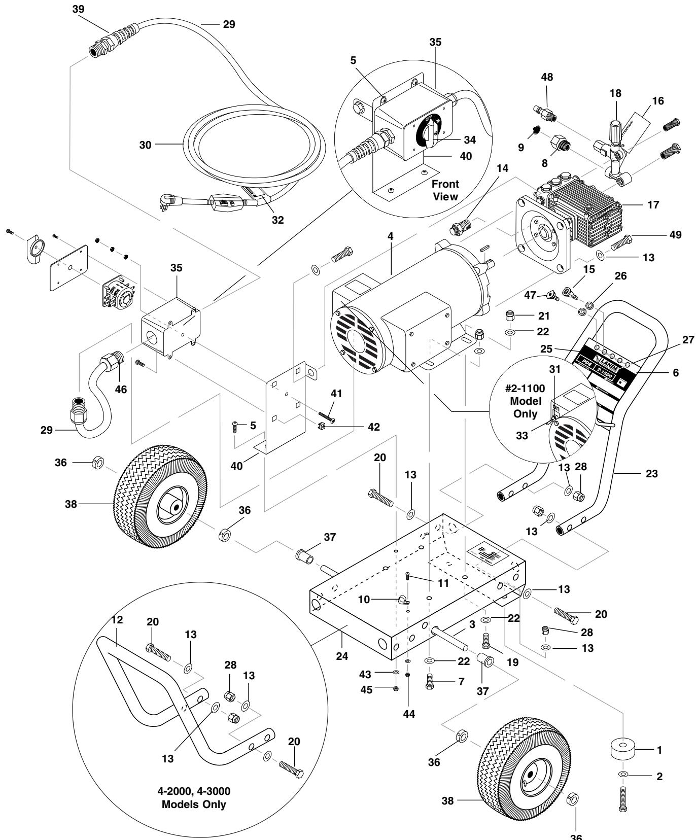
**PDE2-11021D • PDE2-15021D • PDE3-15021A • PDE4-20021A****EXPLODED VIEW PARTS LIST**
